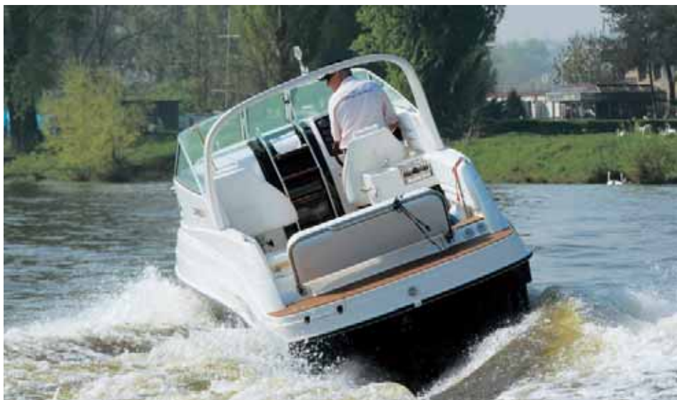
Do testované lodě byl vestavěn motor MerCruiser 3,0L o výkonu 135 koní, s nímž se dvěma osobami na palubě dosáhla rychlosti 47 km/h.
